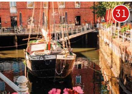
Der 1991 aufwändig restaurierte Ewer ist 1897 gebaut worden und viele Jahre als Frachtschiff zwischen Hamburg und Buxtehude hin- und hergefahren. Das plattbodige Schiff kann mit seinen ausklappbaren Seitenschwertern Ebbe
